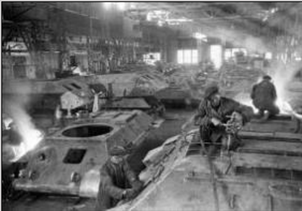
Fertigung von Panzerwannen im Werk Nr. 112
